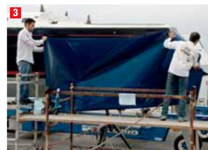
3 Come dei veri e propri sarti applicano la pellicola in modo da seguire la forma dello scafo.
