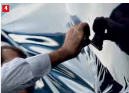
4 Grazie a una tecnica particolare e una pellicola custom, non si hanno né bolle né grinze.
