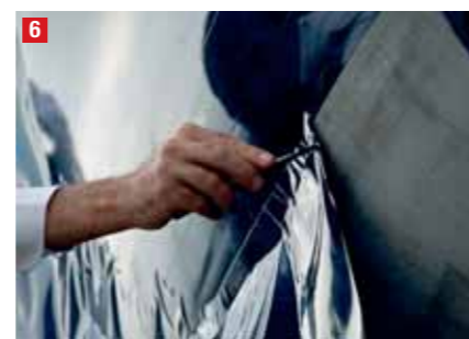
6 Una volta applicata si rifilano i particolari e la pellicola in eccesso.
